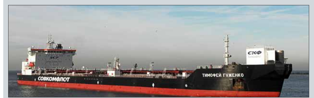
В начале 2009 г. со ступеней южнокорейской «Samsung Shipbuilding & Heavy Industries» сошел первый из трех арктических танкеров для перевозки нефти с Варандейского терминала НК «ЛУКОЙЛ». Головной танкер серии назван в честь министра морского флота СССР Тимофея Гуженко. Судно способно работать при минус 40°C и преодолеть лед толщиной до 1,5 м без буксира. Валовая вместимость более 49 тыс. тонн, девять более 72 тыс. тонн, размеры 257 x 34 x 13,6 м.
